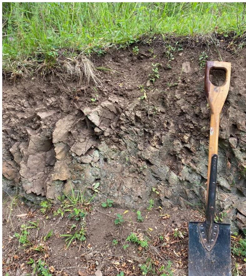
Figura 12 - Perfil de Neossolo litólico, com o horizonte A em contato direto com a rocha.
