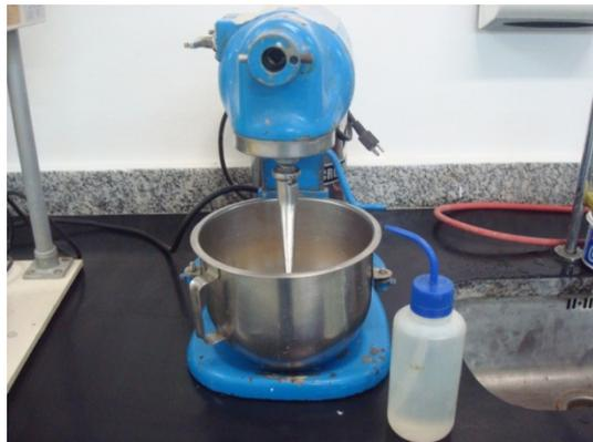
FIGURA 12 – Misturador de bancada utilizado para ensaio de demanda de água
