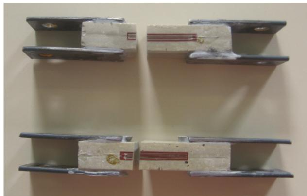
FIGURA 45 – Forma de fratura típica dos corpos de prova ensaiados à tração direta
