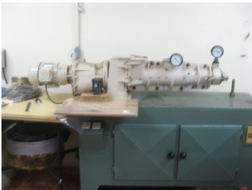
FIGURA 16 – Extrusora de laboratório utilizada para moldagem dos corpos de prova
