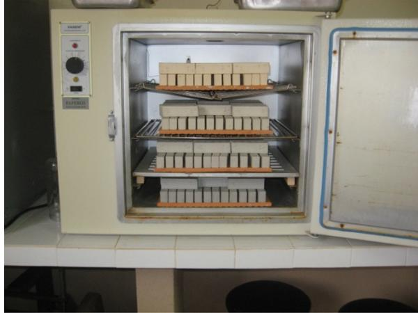
FIGURA 18 – Material seco em estufa
