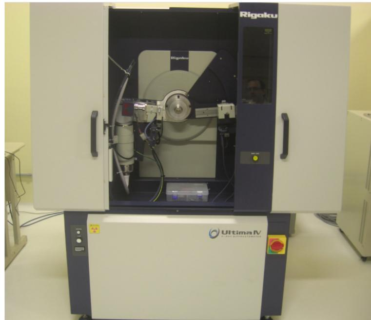
FIGURA 10 - Difratômetro de raios-x
