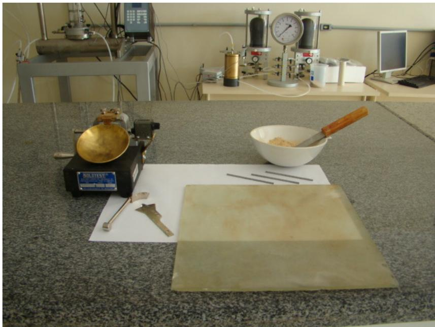
FIGURA 15 – Equipamentos para determinação dos Limites de Atterberg – limite de liquidez, limite de plasticidade e Índice de plasticidade
