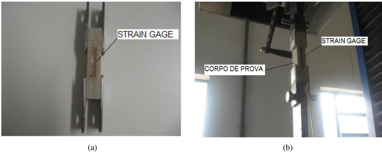
FIGURA 27 – Instrumentação do ensaio de resistência à tração direta: (a) *Strain gage* colado no corpo de prova (b) Corpo de prova sendo tracionado.
