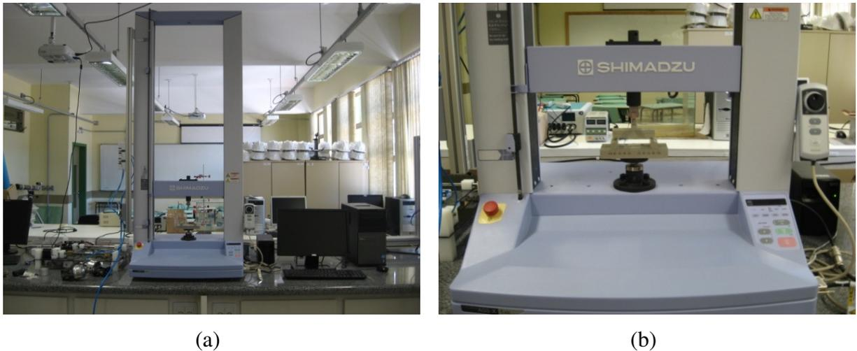
FIGURA 24 – Ensaio de resistência à flexão em três pontos: (a) Equipamento utilizado (b) Corpo de prova sendo ensaiado
