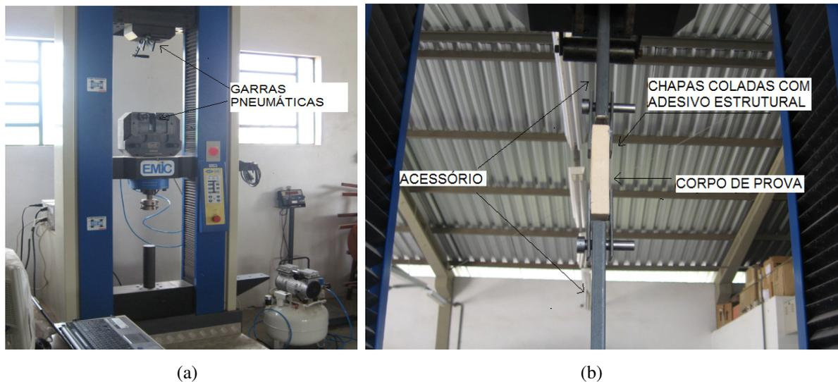
FIGURA 28 – Ensaio de resistência direta à tração: (a) Equipamento utilizado (b) Acessório de fixação do corpo de prova à garra pneumática.
