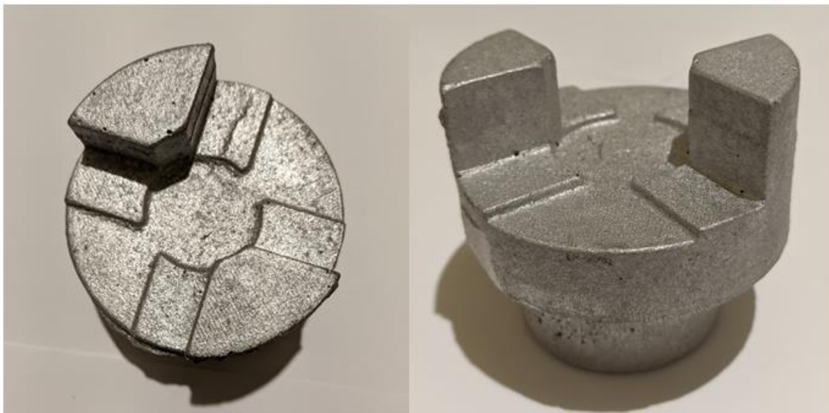
Figura 33 – Acoplamento após limpeza e rebarbação.
