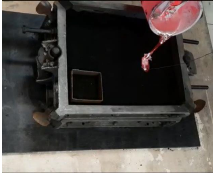
Figura 29 – Vazamento do metal no molde.
