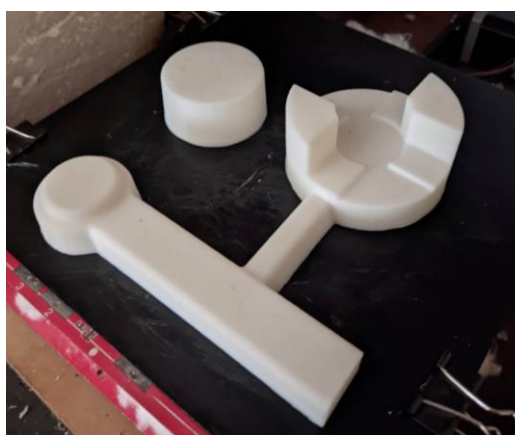
Figura 23 - Impressão parte 2 do modelo inferior com parte dos canais.
