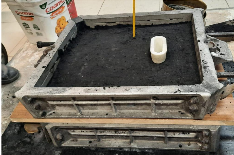
Figura 26 – Placa com a areia já compactada.
