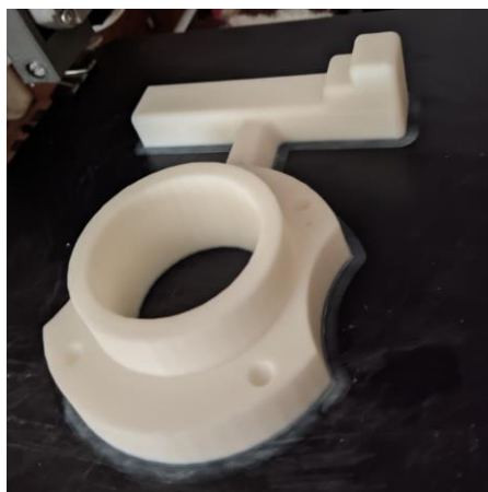
Figura 22 - Impressão parte 1 do modelo inferior com parte dos canais.
