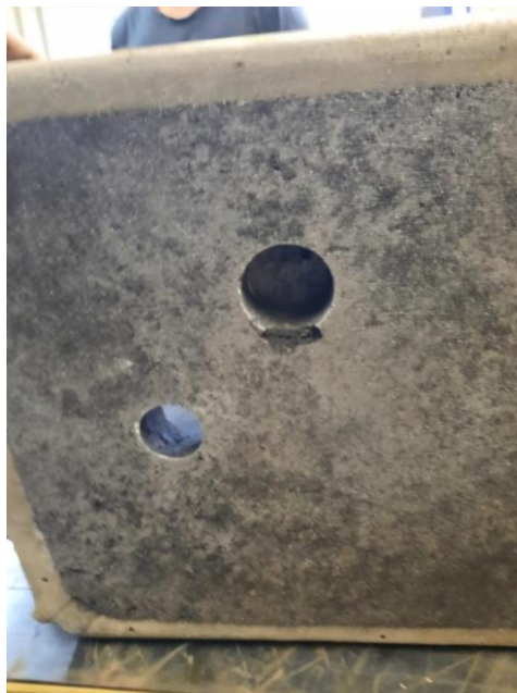
Figura 28 – Parte superior do molde com areia já compactada.
