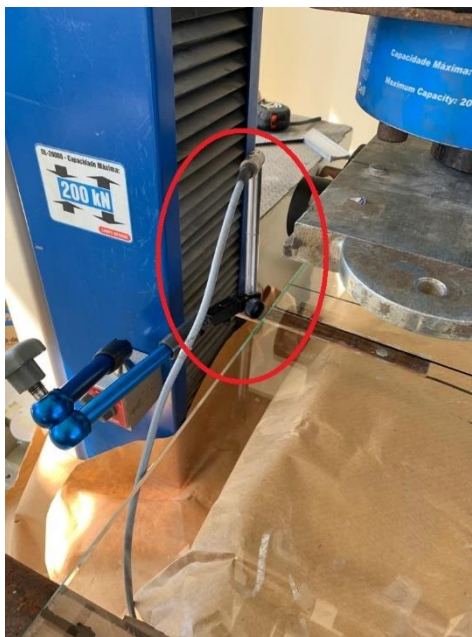
Figura 11 – Aparelho LVDT sendo utilizado no ensaio de tração na flexão.
