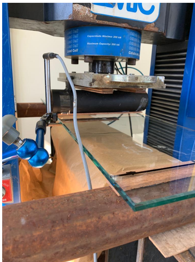
Figura 9 – Corpo de prova antes do ensaio posicionado no equipamento EMIC 2000.
