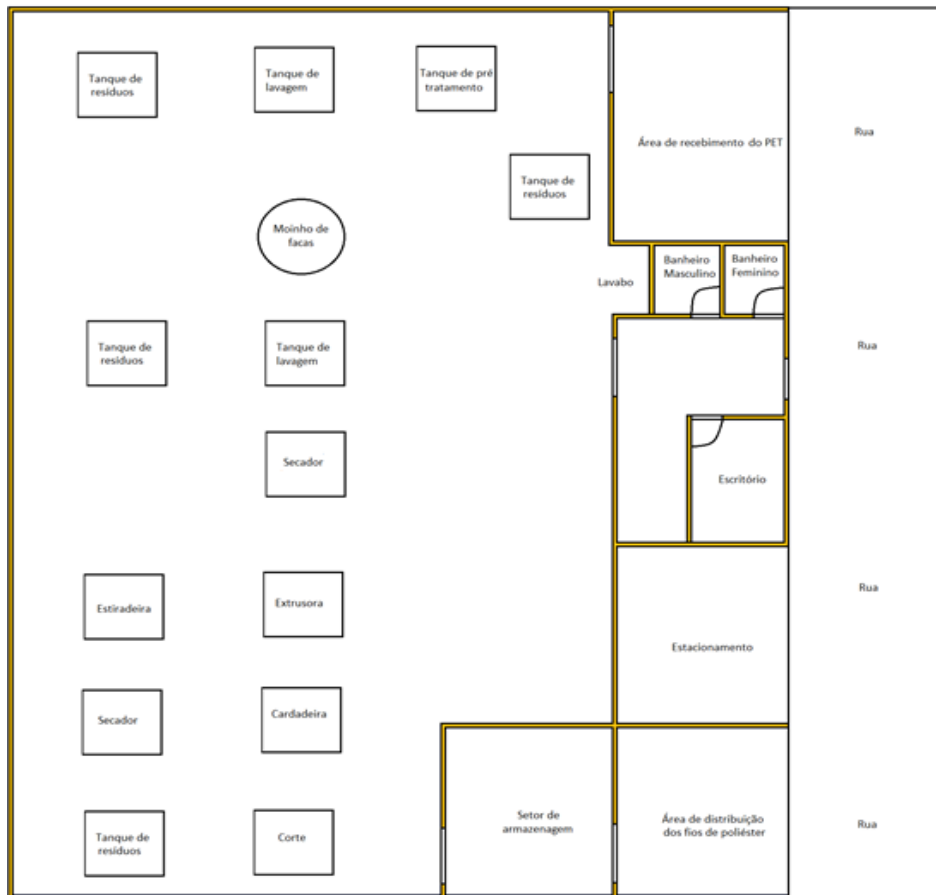
Figura 17 – Layout da instalação industrial.
