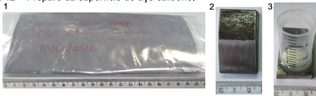
Figura 12 – Preparo da superfície do aço carbono.
