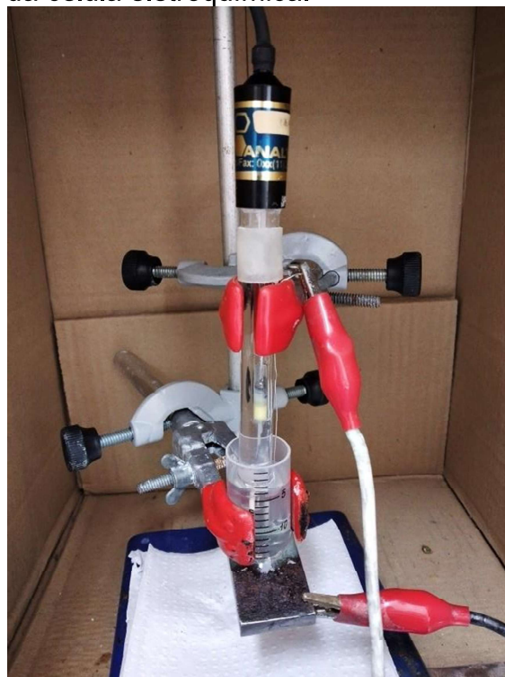
Figura 19 – Detalhe dos três eletrodos da célula eletroquímica.
