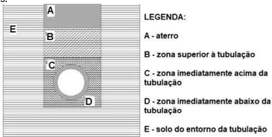
Figura 3 – Seção transversal do solo e áreas preenchidas no entorno de tubulações enterradas.
