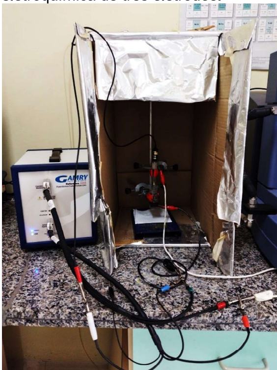
Figura 18 – Montagem da célula eletroquímica de três eletrodos.
