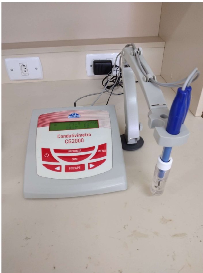
Figura 16 – Medida de condutividade em laboratório.
