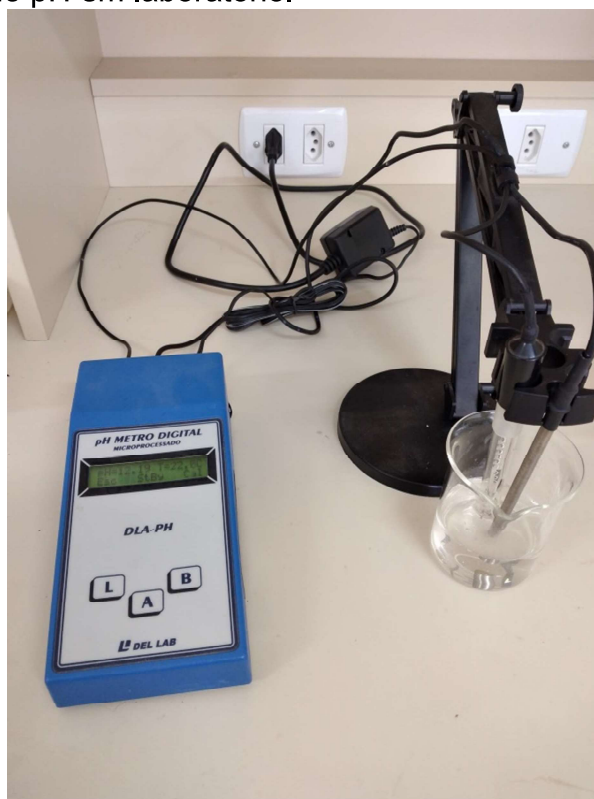
Figura 15 – Medida do pH em laboratório.
