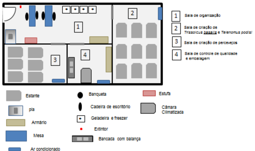
Figura 5 - Proposta para a biofábrica de criação massal de Trissolcus basalis e Telenomus podisi , com os móveis/equipamentos.
