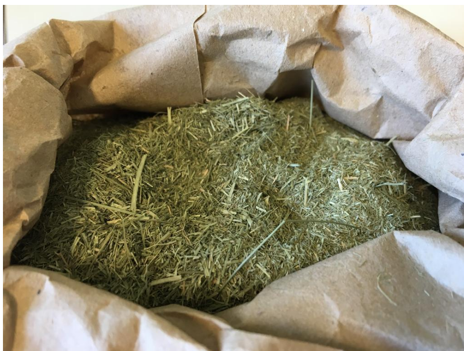
Figura 5 - Aspecto de Eragrostis plana triturada em moinho de facas tipo Willey
