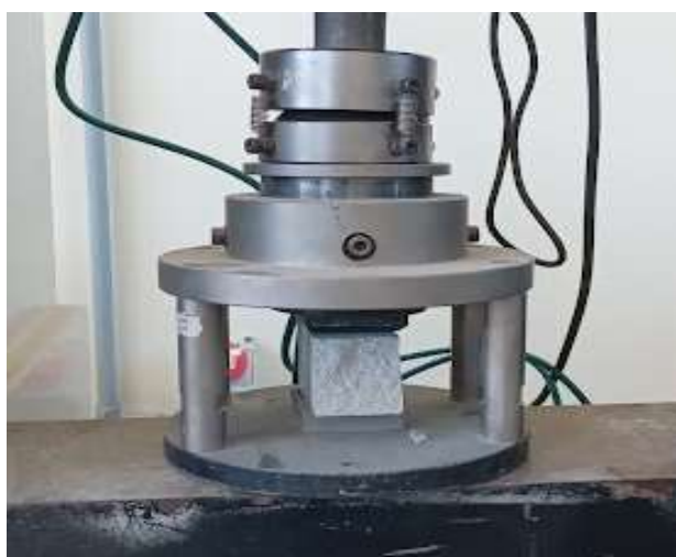
Figura 10 – Ensaio de compressão da argamassa.
