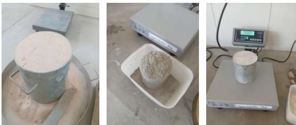
Figura 5 – Ensaio de massa unitária no estado solto.
