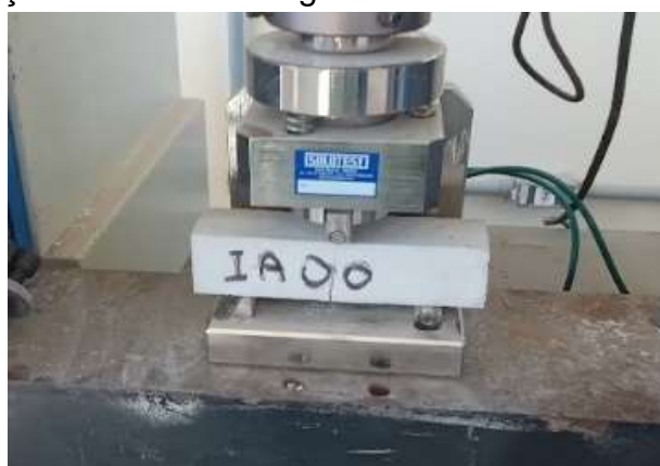
Figura 9 – Ensaio de tração na flexão da argamassa.
