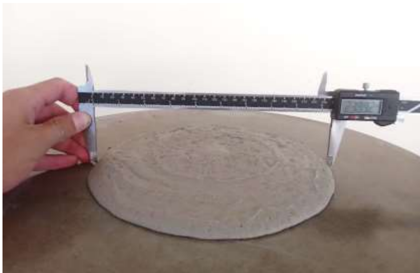
Figura 7 – Ensaio do índice de consistência.
