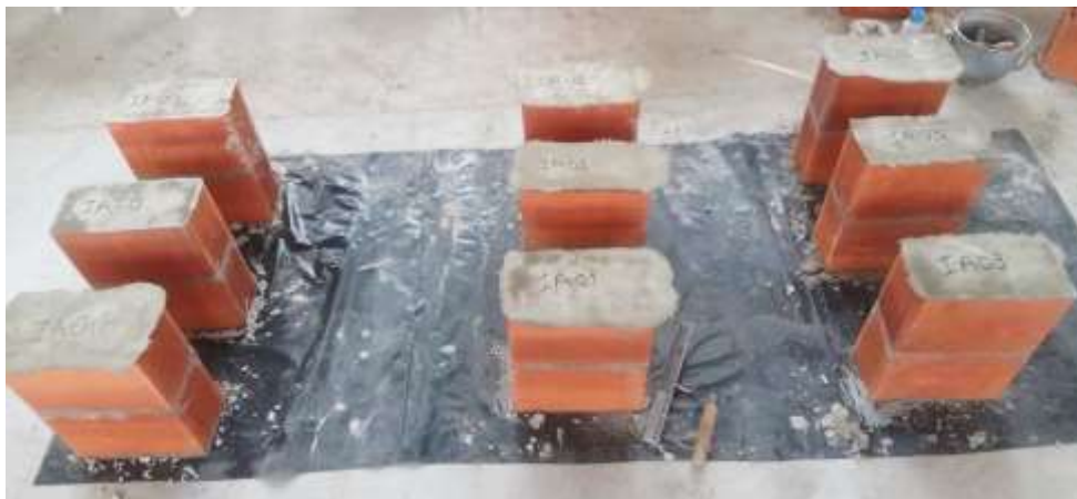
Figura 6 – Confeção dos primas de 2 blocos.
