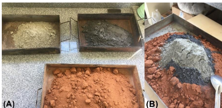
Figura 14. Mistura de solo eólico-cimento-SCA: (A) Bandejas com os materiais utilizados na mistura; (B) Mistura manual dos três materiais.
