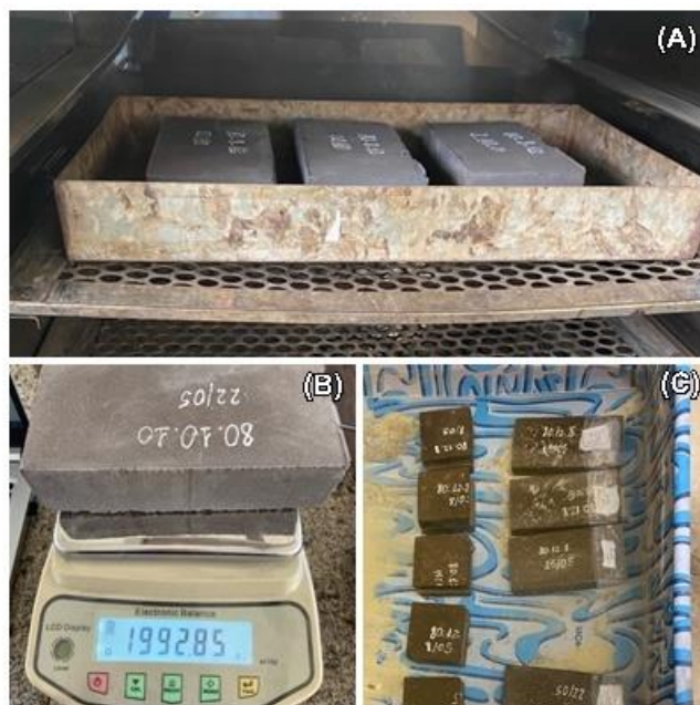
Figura 27. Execução do ensaio de absorção de água no laboratório: (A) Tijolos em estufa à 105 \pm 2 °C; (B) Pesagem em balança de precisão; (C) Tijolos imersos em água para saturação.
