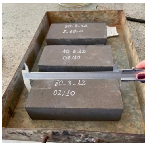
Figura 28. Análise dimensional dos tijolos maciços.
