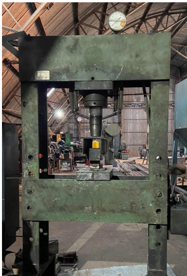
Figura 24. Prensa uniaxial industrial com capacidade de 100 toneladas utilizada para prensagem dos tijolos maciços.
