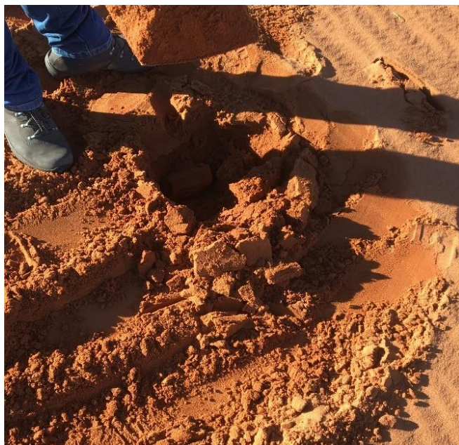
Figura 11. Coleta de amostras deformadas de solo eólico.
