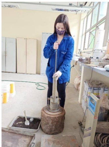
Figura 15. Execução do ensaio de compactação dinâmica (com energia de Proctor Normal).
