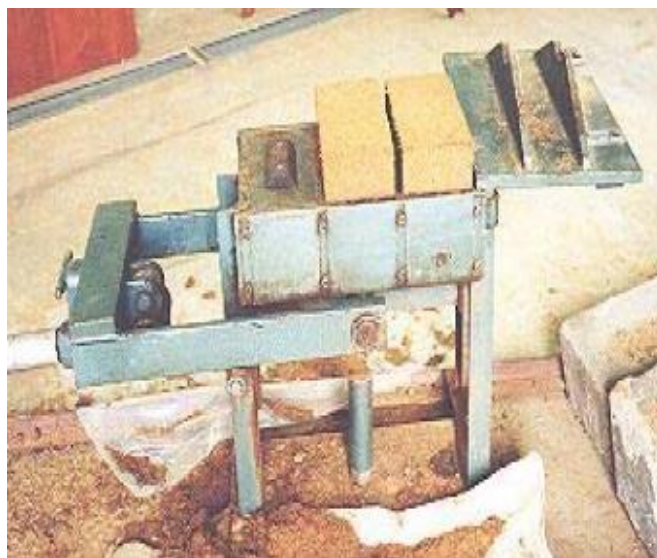
Figura 3. Prensa manual para moldagem de tijolos maciços.
