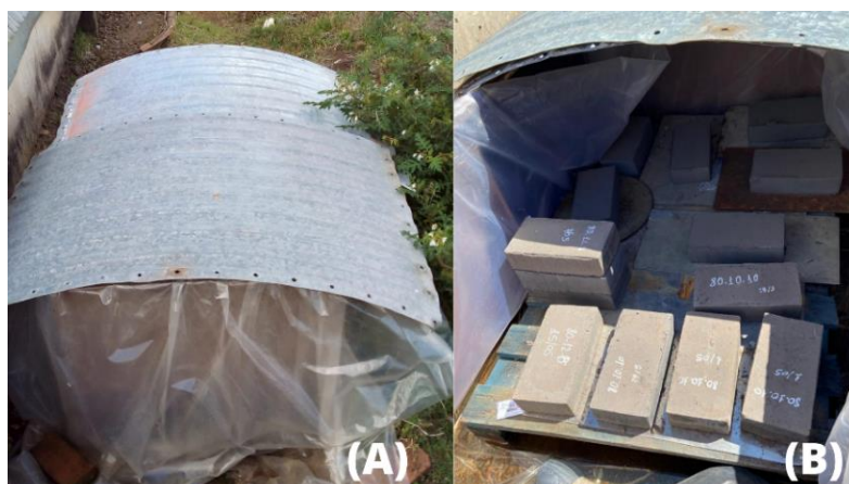
Figura 26. Estrutura para cura dos tijolos maciços. (A): Estrutura fechada, parte externa; (B): Estrutura aberta, parte interna.
