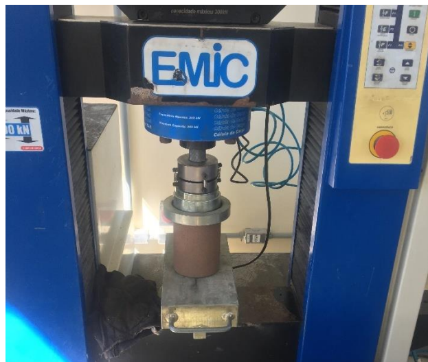
Figura 17. Ensaio de resistência à compressão simples em corpos-de-prova cilíndricos.
