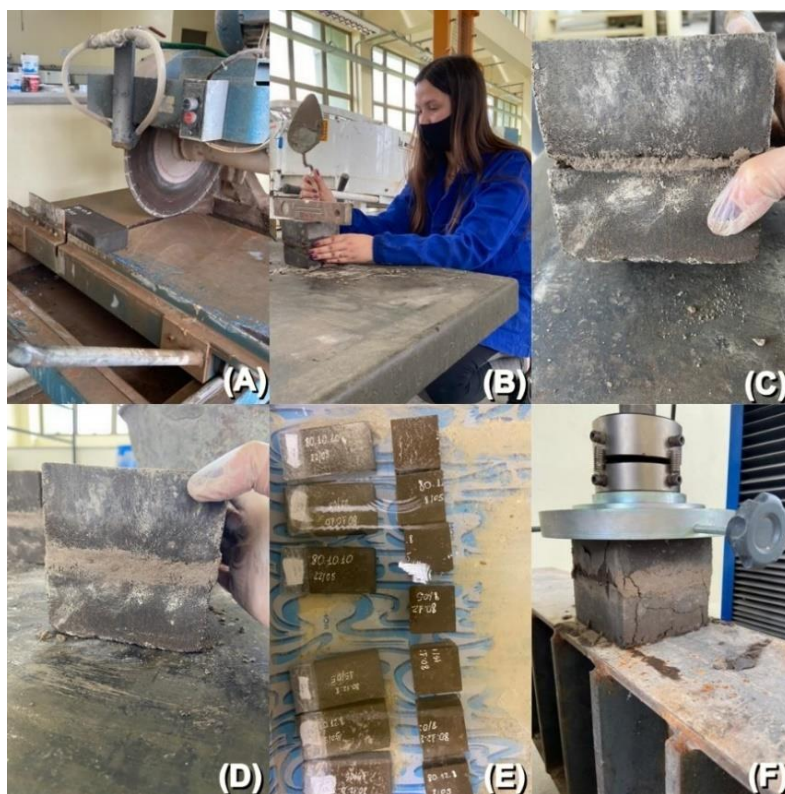
Figura 29. Etapas do ensaio de resistência à compressão simples no laboratório: (A) Corte; (B) Capeamento; (C) Espessura do capeamento de até 3mm; (D) Capeamento finalizado; (E) Processo de cura; (F) Compressão simples.
