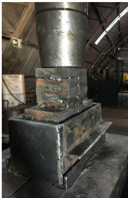
Figura 25. Confeção dos tijolos maciços com molde metálico no momento de prensagem.
