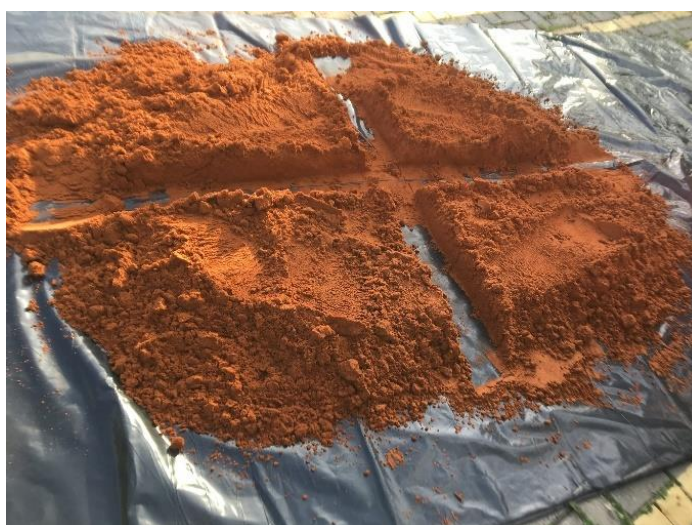
Figura 12. Preparo (quarteamento) das amostras de solo eólico para ensaios de caracterização.
