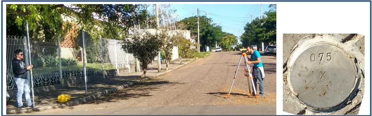
Figura 19 – Nivelamento geométrico e chapa metálica enumerada
