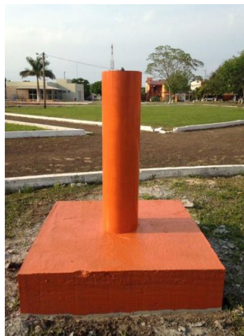
Figura 3 – Pilar geodésico dotado de dispositivo de centragem forçada.
