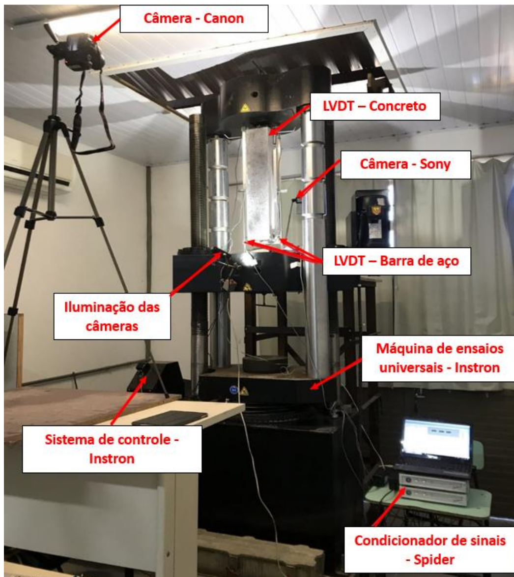
Figura 46. Procedimento de ensaio para ensaio de tração de tirante.
