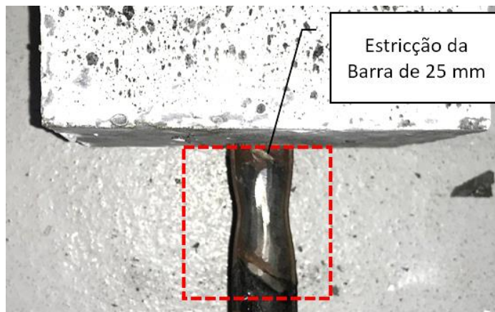
Figura 89. Estrição da barra de 25 mm no grupo C2.H.25.
