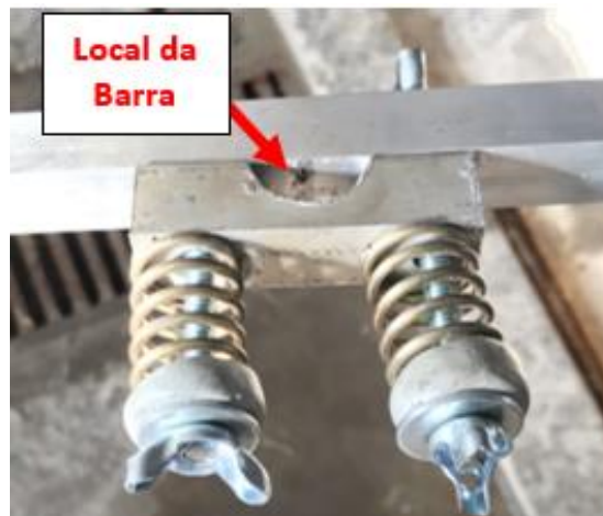
Figura 38. Molas de pressão usadas para garantir a fixação do aparato usado nas leituras dos LVDT's na barra de aço.
