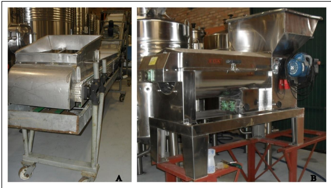
Figura 1 – A: Esteira de Seleção. B: Desengaçadeira
