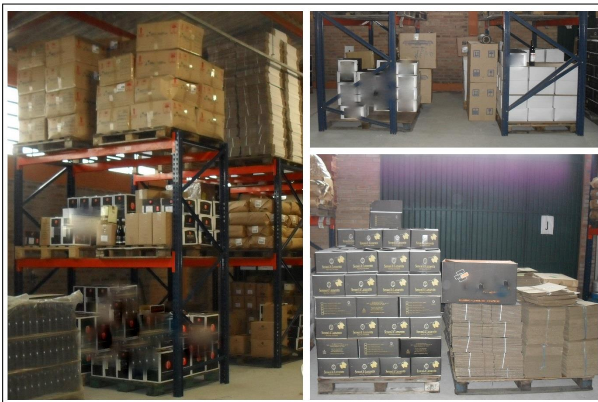
Figura 17 – Armazenamento inadequado de caixas
