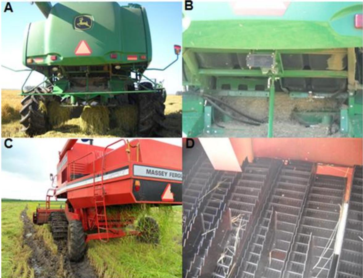
FIGURA 7 – (A, B) sistema de trilha por rotor axial, (C, D) sistema de trilha por saca-palha
