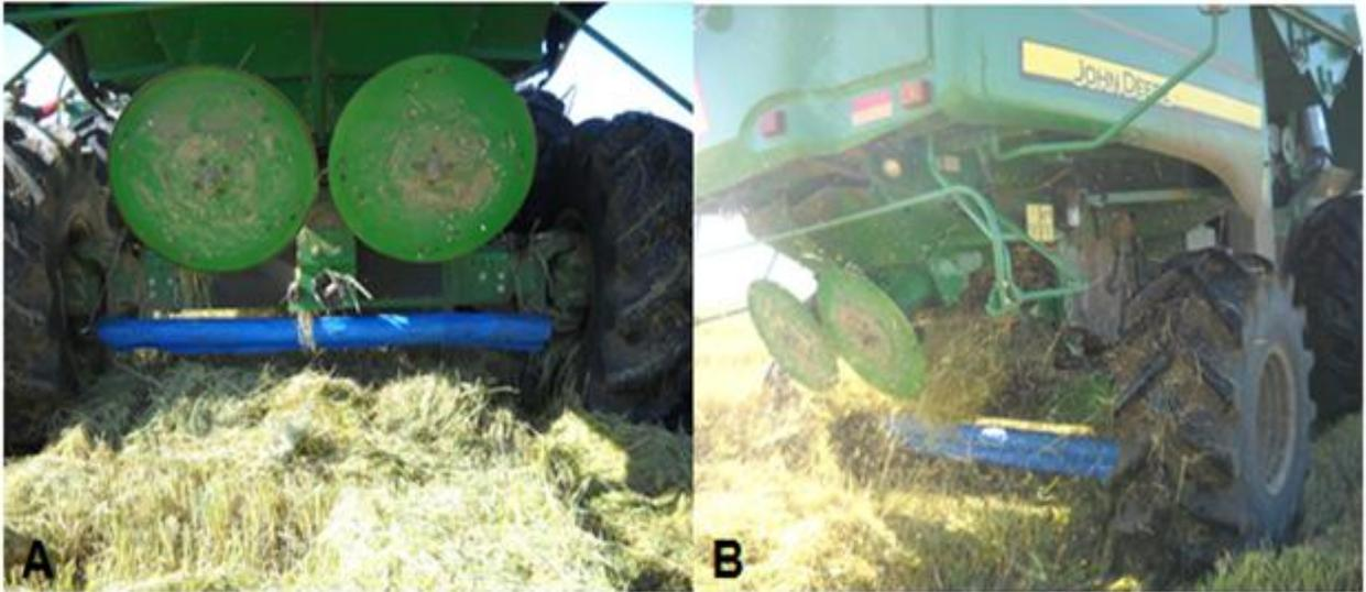
FIGURA 8 - Esquema de amarração da lona no eixo traseiro da máquina (A,B).
