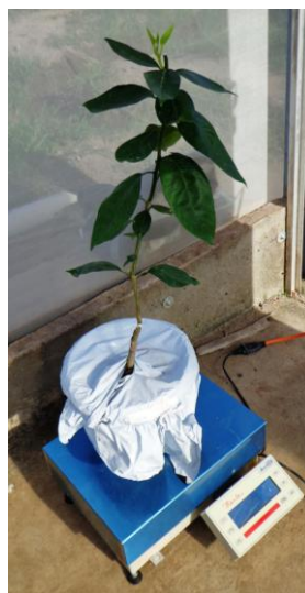
FIGURA 4 - Determinação da massa dos vasos com mudas de laranjeira 'Jaffa' sobre porta enxerto Poncirus trifoliata em uma balança eletrônica. Itaqui, RS, 2012.
