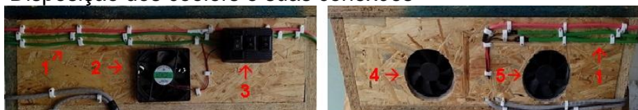
Figura 25- Disposição dos coolers e suas conexões
