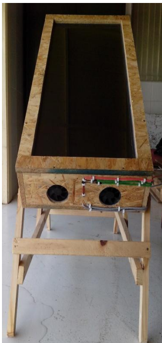
Figura 24- Coletor solar térmico finalizado
