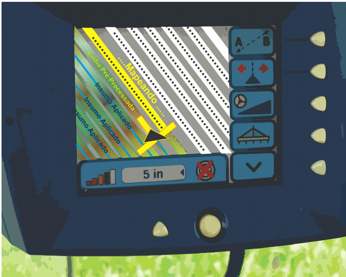
Figura 28 – Mapeamento frontal e lateral permitindo pré-processar a altura média do pasto da linha futura
