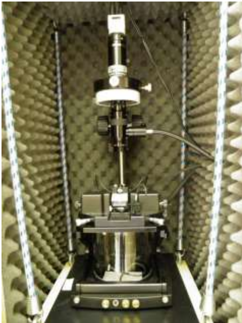
Figura 27 – Microscópio de Força Atômica (a) e imagem da grade para calibração das barras nas imagens da microscopia ótica (b).
