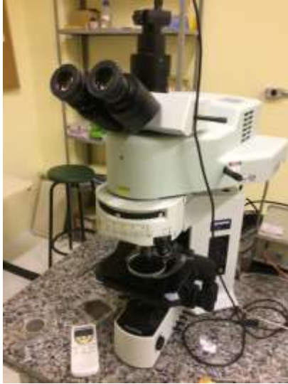
Figura 26 – Microscópio óptico com câmara de CCD acoplada (a) e imagem da grade para magnificação de 50x(b).
