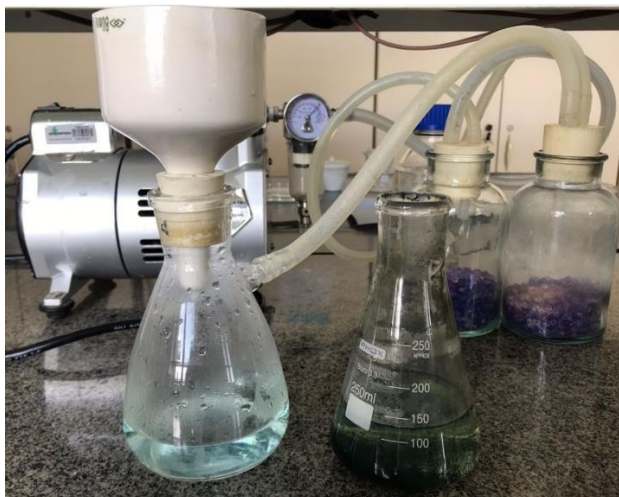
Figura 8 – Sistema de filtragem do precipitado de CuS
