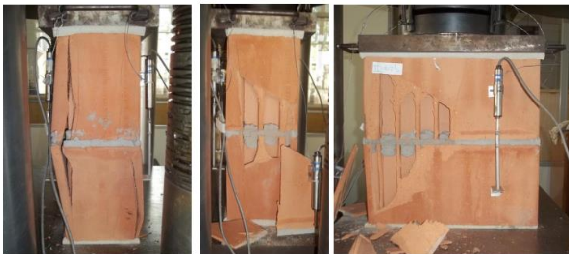
Figura 2 - Exemplo prismas de blocos cerâmicos rompidos a compressão axial.
