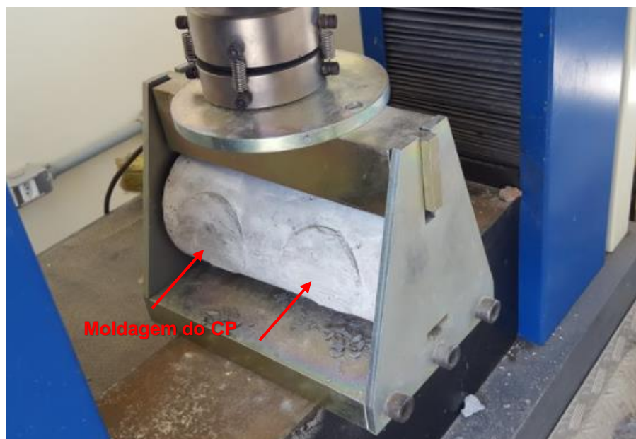
Figura 32 – Posição do corpo de prova na prensa
