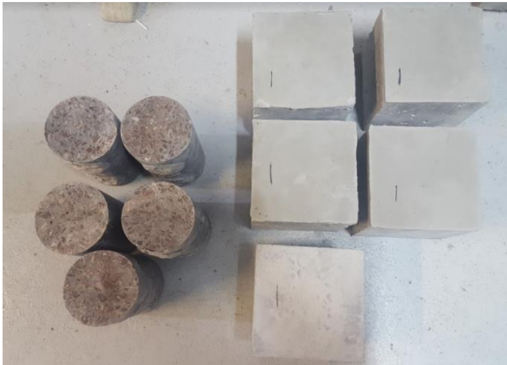
Figura 30 – Corpos de prova (C0) prontos para ensaio à compressão axial – (a) e (b)
