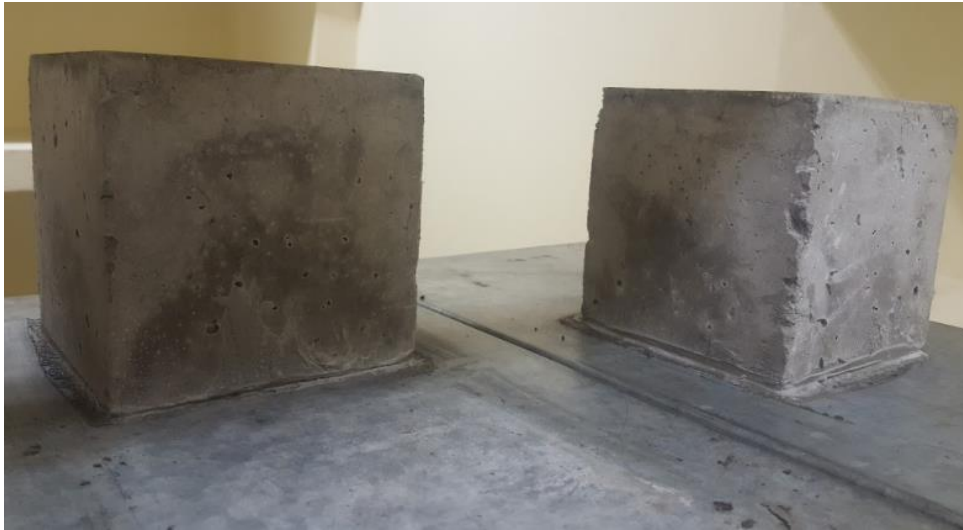
Figura 29 – Capeamento dos CPs cúbicos – concreto C0
