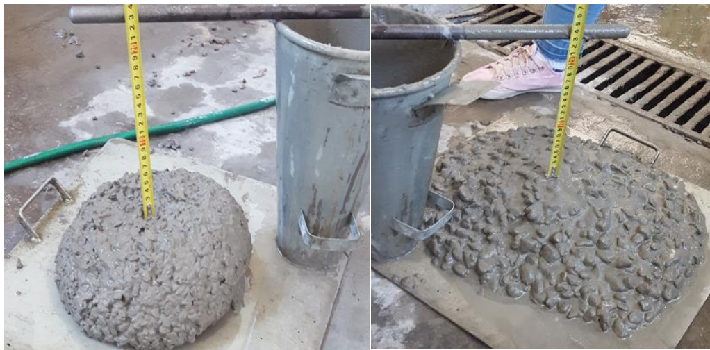
Figura 18 - Análise do abatimento dos concretos C0 (a), C1 (b) e C2 (c)
