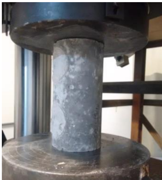
Figura 35 – Carregamento \perp à moldagem.
