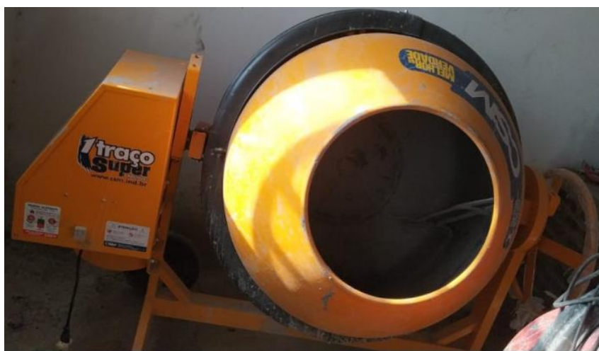
Figura 20 - Betoneira utilizada para a produção dos concretos
