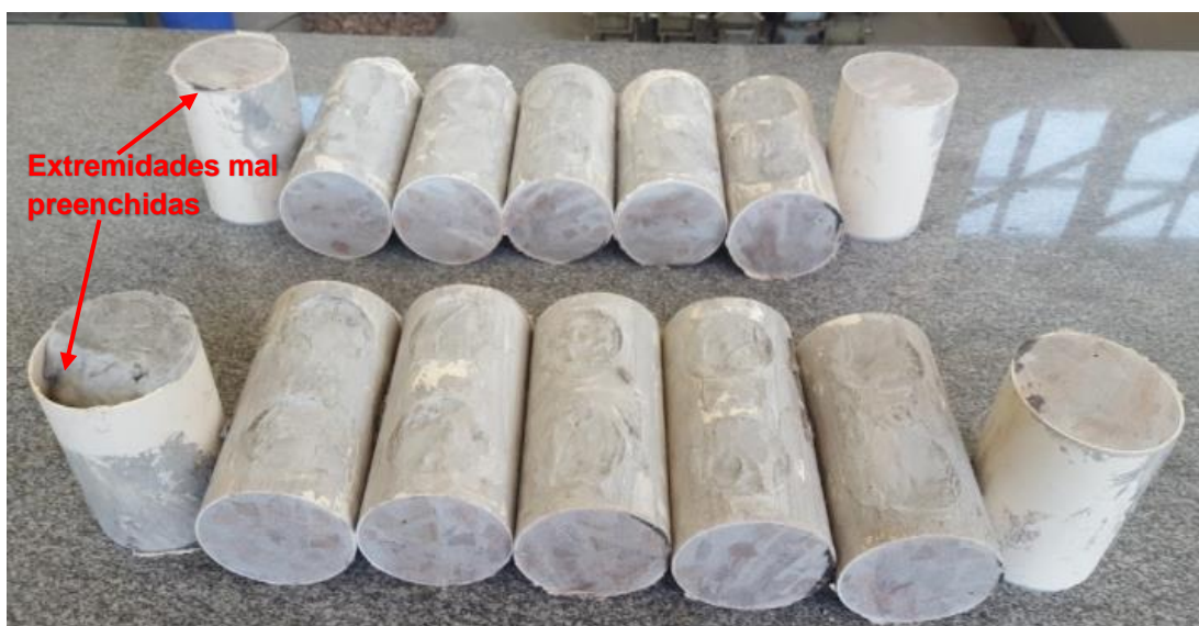
Figura 25 – Cortes dos Tubos de PVC
