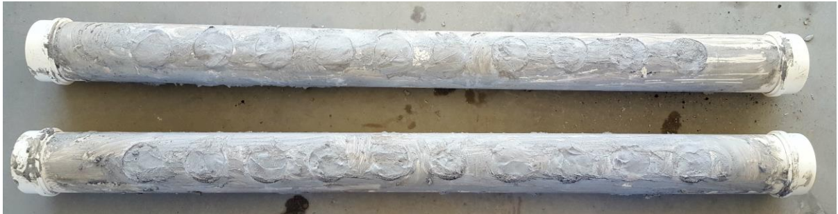
Figura 24 – Moldes preenchidos com concreto
