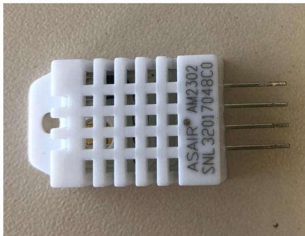
Figura 16: Sensor DHT22.
