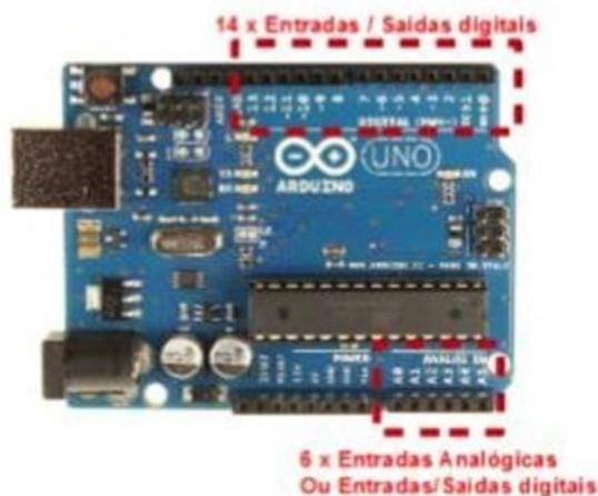
Figura 2: Localização das Entradas e Saídas do Arduino
