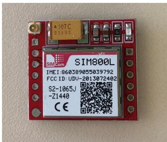
Figura 17: Módulo GSM/GPRS.
