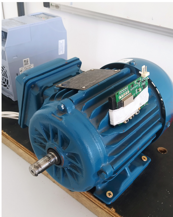
Figura 37 – Motor elétrico instalado em bancada com o protótipo do medidor de vibrações fixado através de adesivo dupla face em aleta de refrigeração do motor.
