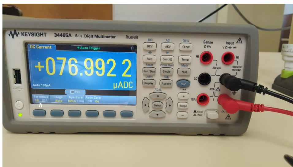
Figura 34 – Imagem aproximada do multímetro digital utilizado para medição de corrente do sistema em deep sleep .
