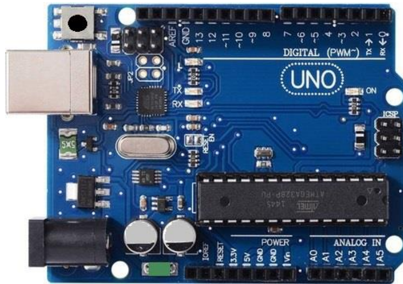
FIGURA 15 – Arduino UNO R3
