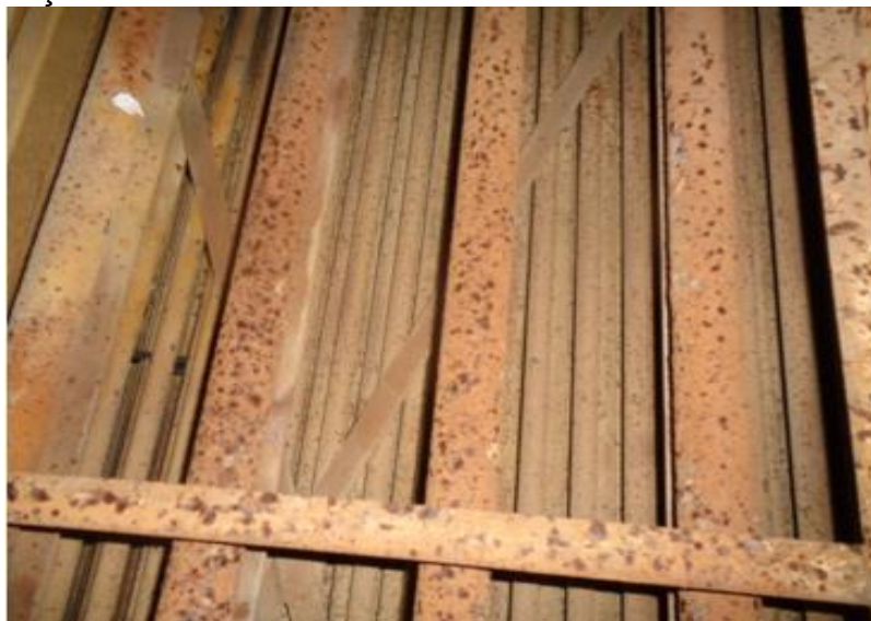
Figura 17 – Incrustações em condensador desativado
