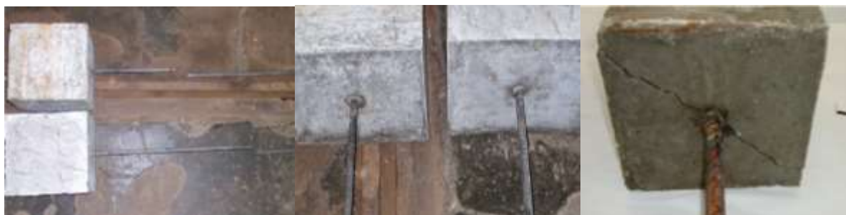
Figura 3 – Tipos de ruptura de aderência: ruptura do aço, deslizamento das barras de aço e ruptura por fendilhamento.
