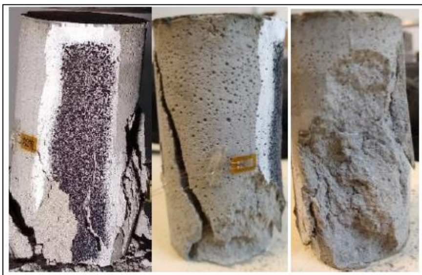
Figura 05: Ruptura dos Corpos de Prova – Traço (1:0,5:4), altura de 100 mm.
