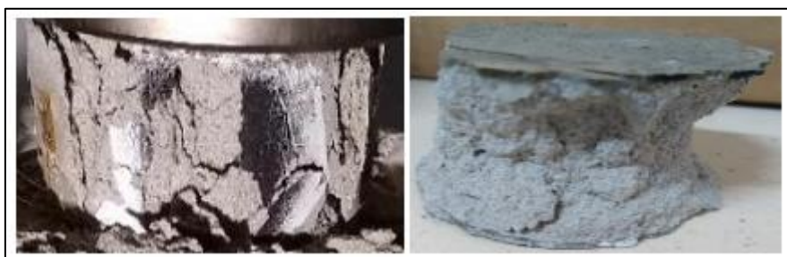
Figura 06: Ruptura dos Corpos de Prova – Traço (1:0,5:4), altura de 33 mm.
