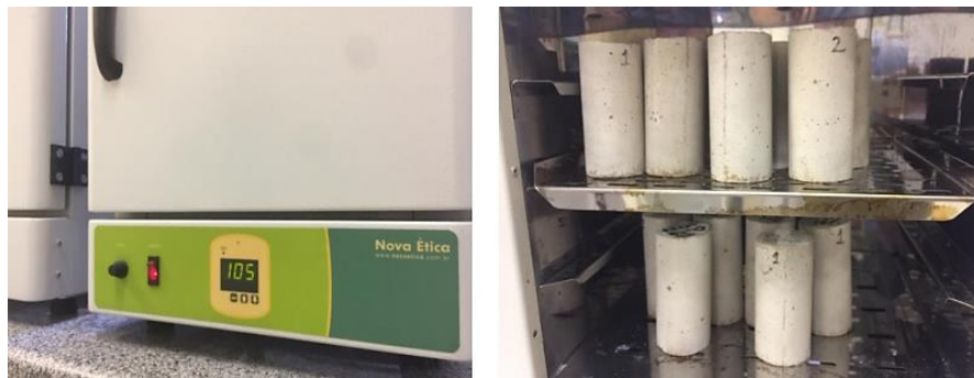
Figura 23 – Corpos de prova em estufa a 105°C
