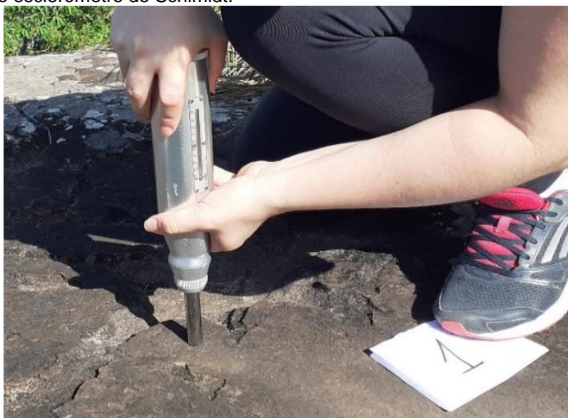
Figura 11- Ensaio esclerômetro de Schimidt.
