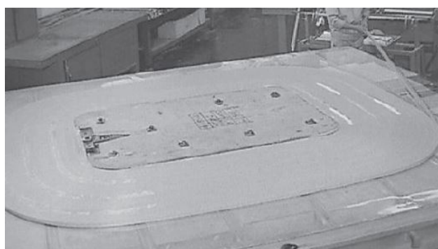
Figura 2.8 – Fabricação do enrolamento do tipo panqueca.
