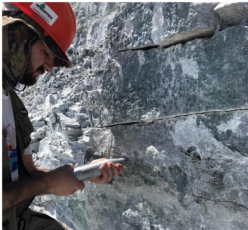
Figura 33 - Aplicação do Esclerômetro de Schmidt na superfície de uma descontinuidade para obtenção do valor de rebote.
