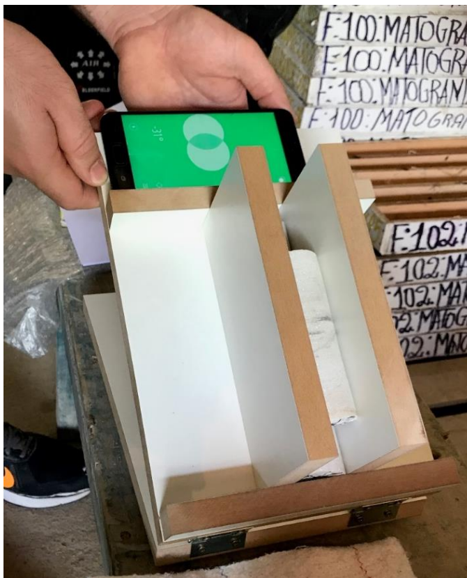
Figura 28 - Uso de um smartphone como ferramenta para medir o ângulo em que um corpo de prova desliza sobre o outro
