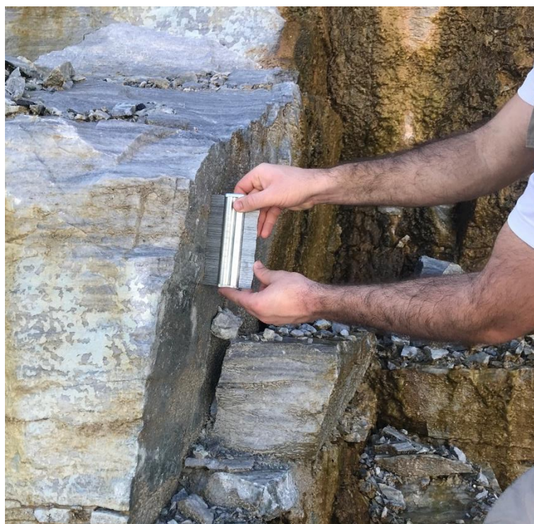
Figura 17 - Cópia da rugosidade da superfície da descontinuidade através do uso do Perfilômetro de Rugosidade
