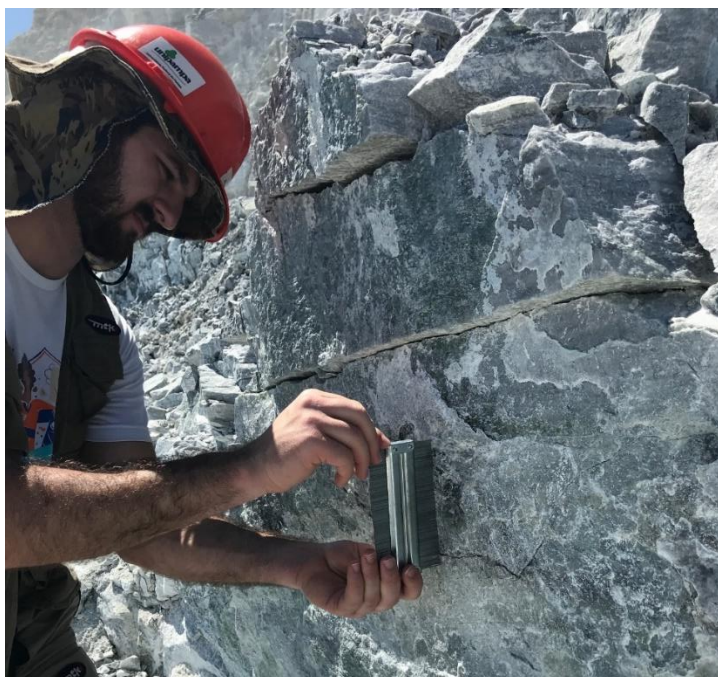
Figura 26 - Uso do Perfilômetro de Rugosidade para estimativa do valor do JRC
