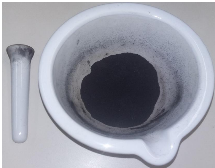
Figura 3.6 - CSM obtida após a queima na temperatura de 400°C no tempo de 60 minutos
