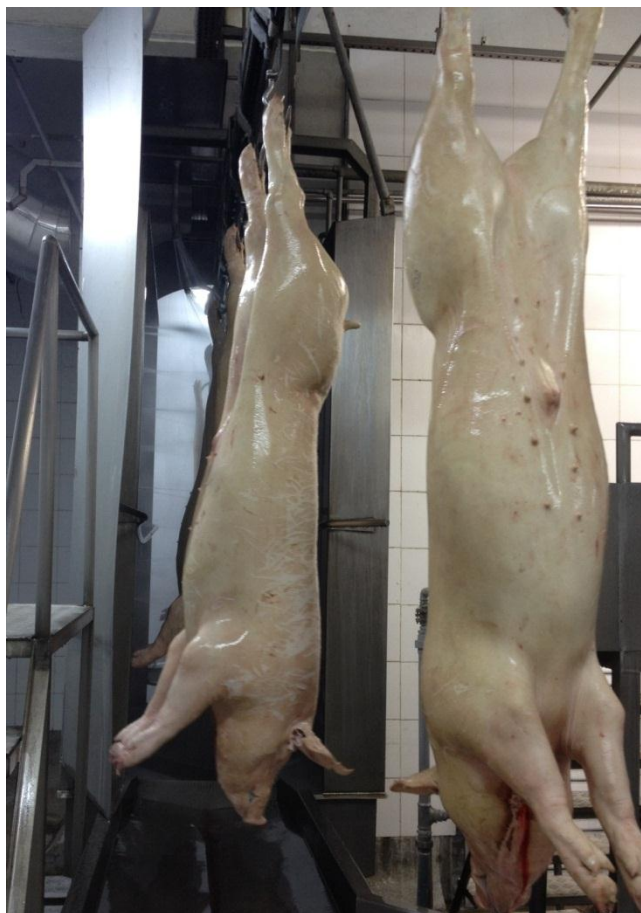
Figura 7 – Passagem das carcaças pelo chuveiro pré-evisceração, na entrada da área limpa (Fonte: Autor)
