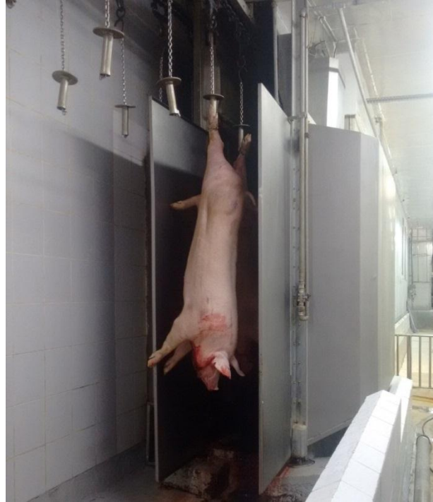
FIGURA 5 – Entrada das carcaças no túnel de escaldagem, com objetivo de facilitar a remoção das cerdas (Fonte: Autor)
