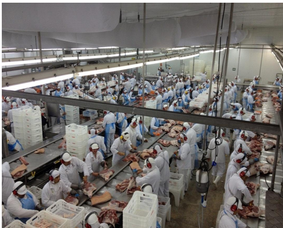
FIGURA 11 – Sala de desossa das carcaças, onde são realizados cortes e embalagem dos produtos (Fonte: Autor)
