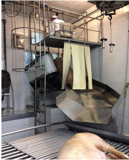
FIGURA 4 – Área de insensibilização por eletrocussão, e esteira de sangria (Fonte: Autor)
