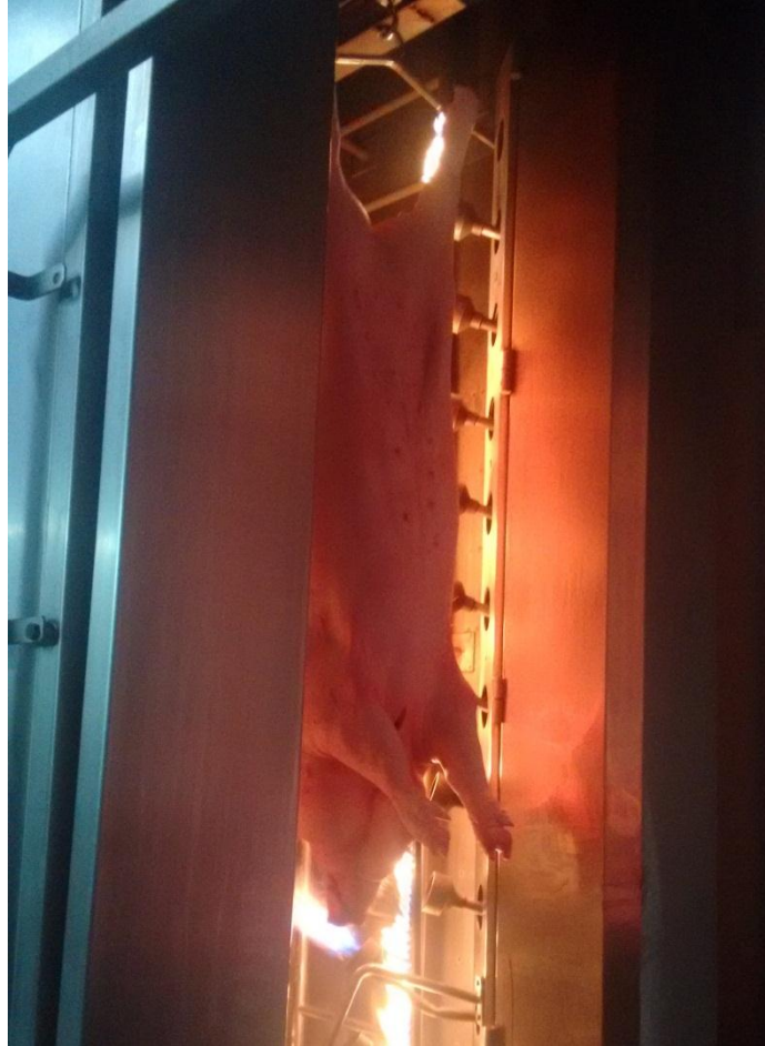
Figura 6 – Passagem da carcaça pelo chamuscador (Fonte: Autor)
