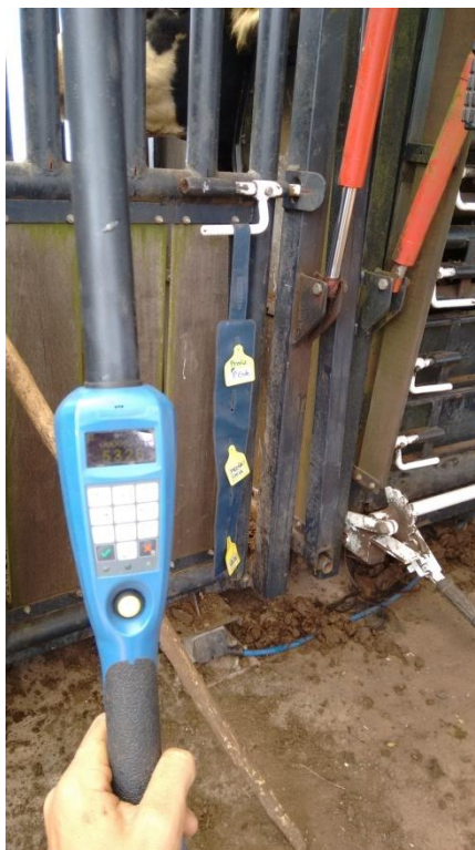
FIGURA 18 – Bastão de rastreabilidade Baqueano , sendo usado durante o diagnóstico de gestação. Fonte: Arquivo pessoal.
