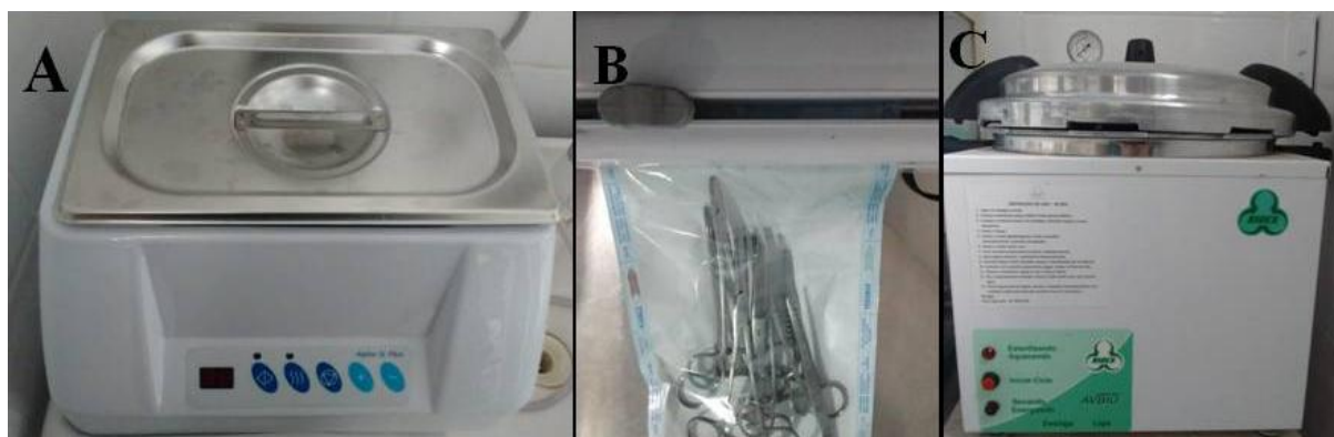
FIGURA 4 – Equipamentos da sala de esterilização de material cirúrgico. A. Lavadora ultrassônica de material cirúrgico. B. Seladora de embalagens com instrumentos a serem esterilizados. C. Autoclave.
