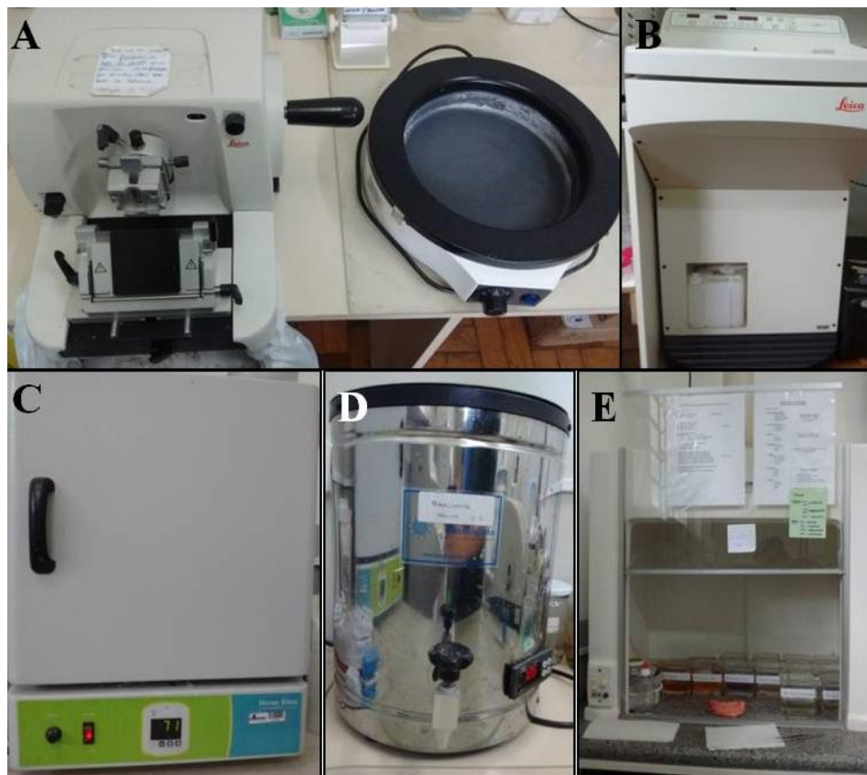
FIGURA10– Equipamentos da sala de Histopatologia. A. Micrótopo e banho maria histológico. B. Criostato. C. Estufa. D. Dispensador de parafina aquecida. E. Capela de fluxo laminar.
