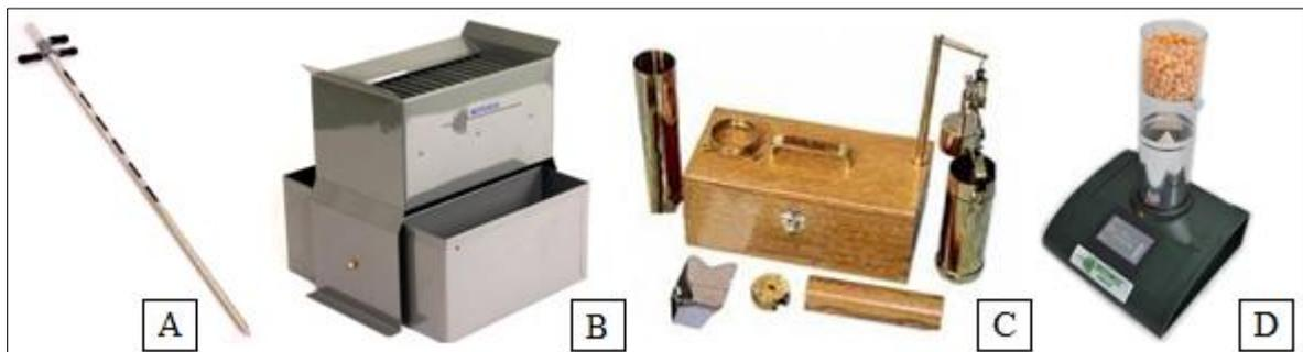
FIGURA 4 - Equipamentos usados para análises físicas em testes de liberação de cargas de matérias-primas: A- Calador; B- Quarteador; C- Balança Ph; D- Medidor de umidade.
