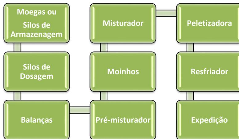
FIGURA 3 - Fluxograma resumido do funcionamento da Fábrica de Rações.
