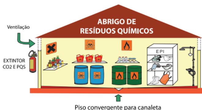
Figura 5 - Armazenamento externo de resíduos do grupo B
