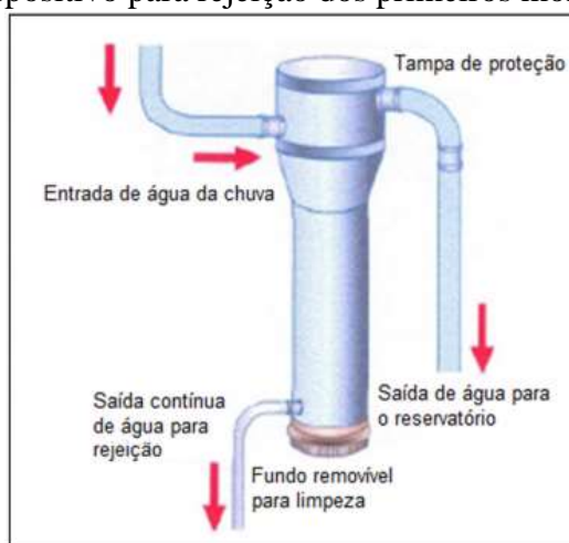
Figura 11 - Dispositivo para rejeição dos primeiros momentos de chuva
