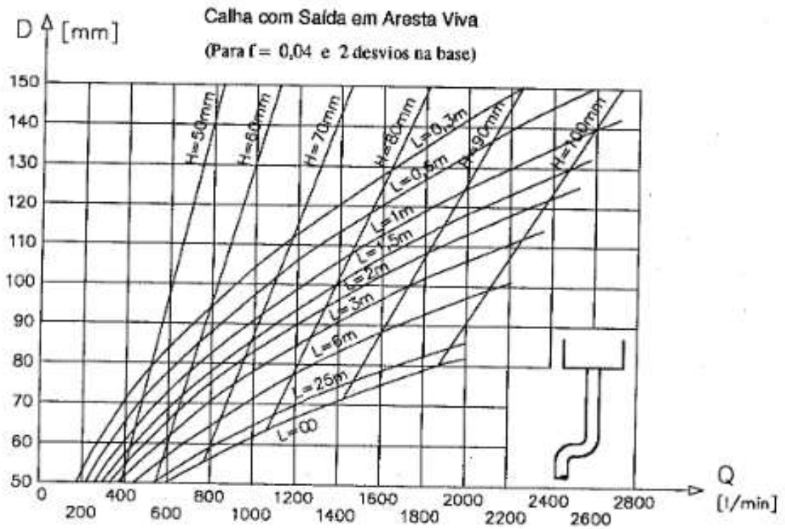
Figura 17 – Ábaco para calha com saída em aresta viva
