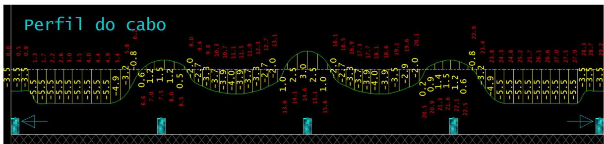
Figura 59 - Perfis dos Cabos RPU 6
