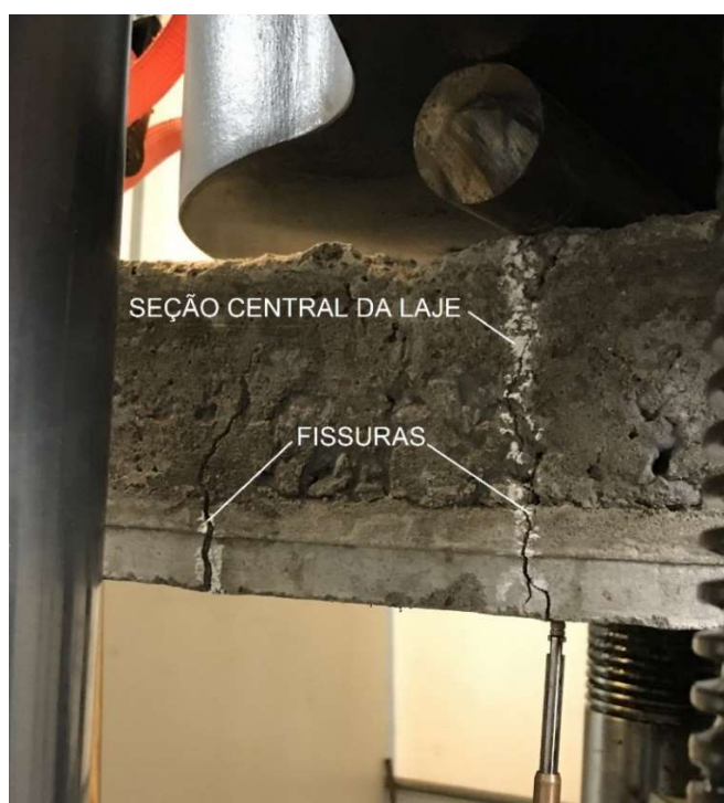
Figura 43 – Fissuração durante um ensaio de lajes com vigotas protendidas
