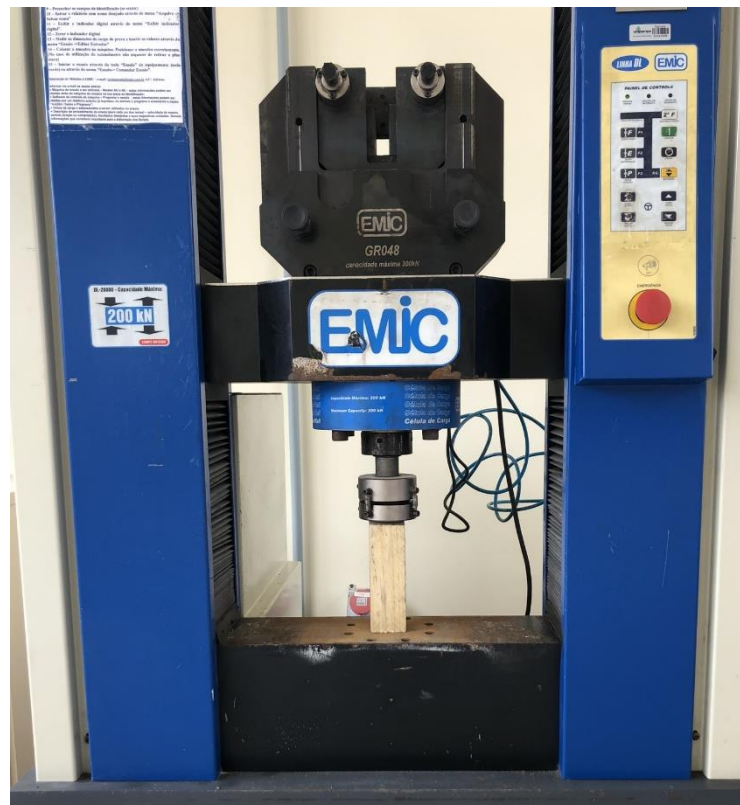
Figura 15 - Arranjo de ensaio para compressão paralela às fibras na prensa DL 20000
