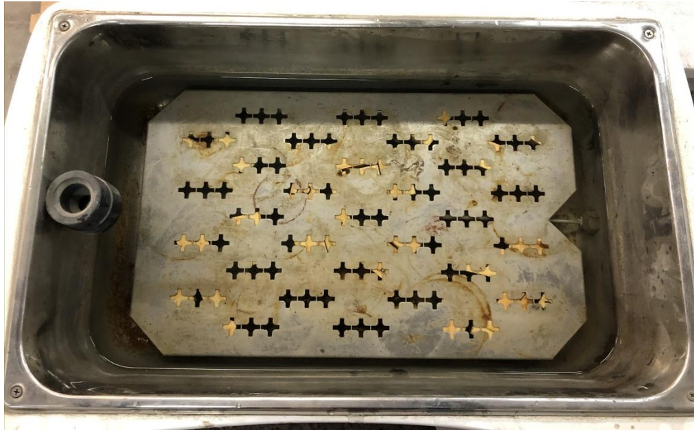
Figura 11 – Corpos-de-prova submersos no equipamento de banho maria
