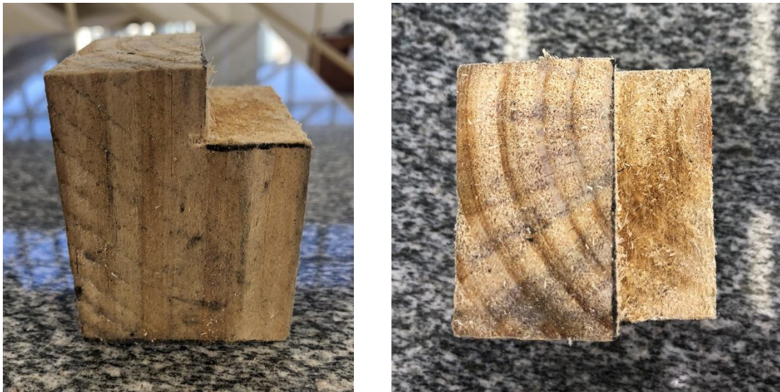
Figura 22 - Corpo-de-prova para o ensaio de resistência ao cisalhamento paralelo às fibras
