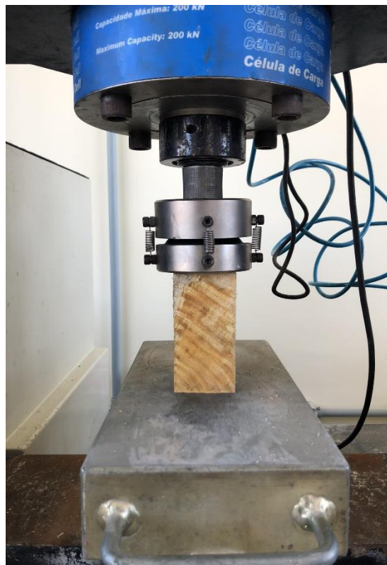
Figura 19 - Arranjo de ensaio para compressão normal às fibras na prensa DL 20000
