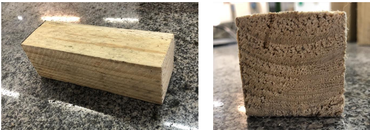
Figura 13 - Corpo-de-prova para o ensaio de resistência a compressão paralela às fibras
