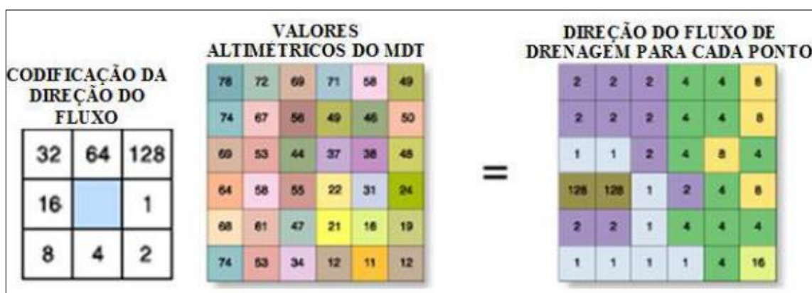
Figura 21 (a) Codificação das direções (b) Atribuição de direção método D8.
