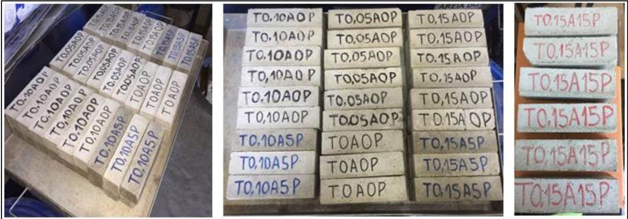
Figura 7 – Corpos de prova prismáticos ensaiados no estado endurecido
