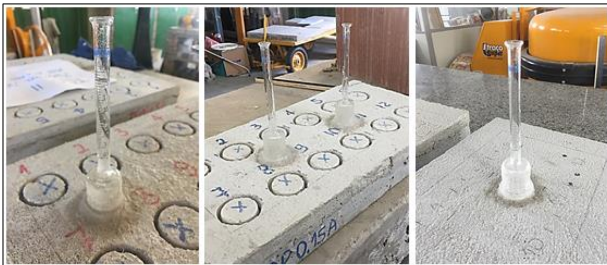
Figura 8 – Execução do ensaio de absorção de água por capilaridade pelo método do cachimbo
