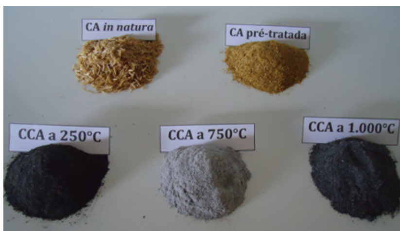
FIGURA 9 – Ilustração de todas as biomassas preparadas para serem utilizadas no tratamento do efluente
