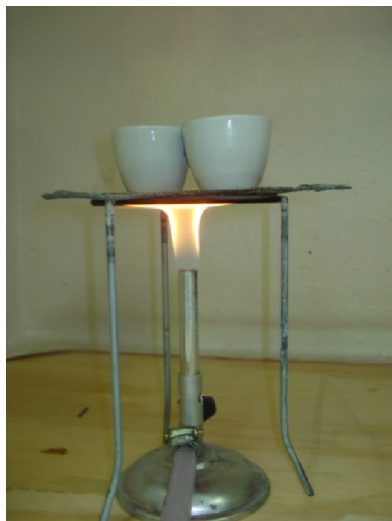
FIGURA 8 – Amostras de CA sendo calcinada no bico de bunsen dentro da capela de exaustão
