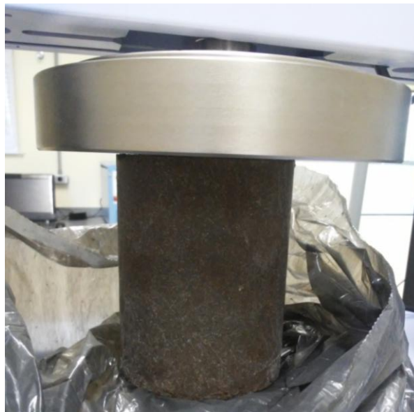
Figura 16 – CP pronto para ser rompido Fonte: Autoria Própria
