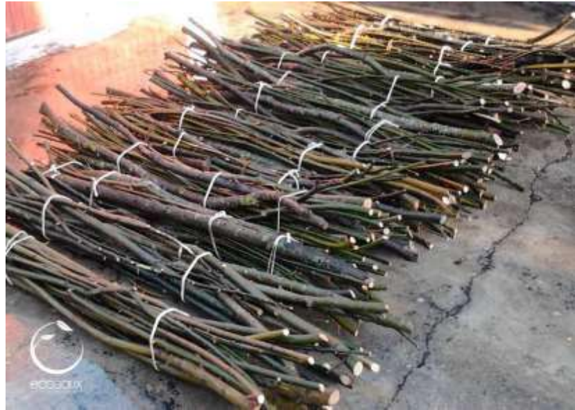
Figura 8: Feixes vivos prontos para aplicação. FONTE: Ecosalix (2016). Disponível em: < http://ecosalix.pt/faxina-viva >
