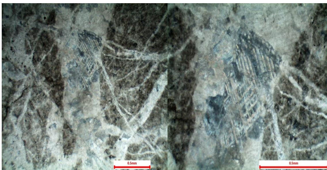
Figura 13 – Fotomicrografia de fraturas preenchidas por calcita - aumento de 5x. Luz Polarizada
