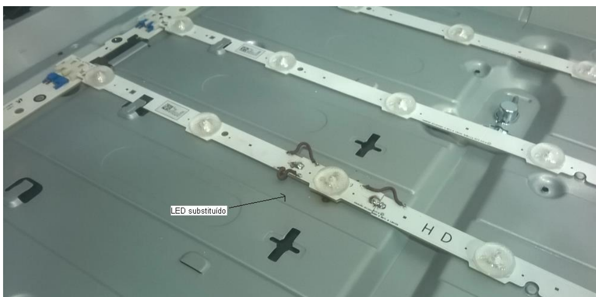
FIGURA 13 - LED defeituoso já substituído.
