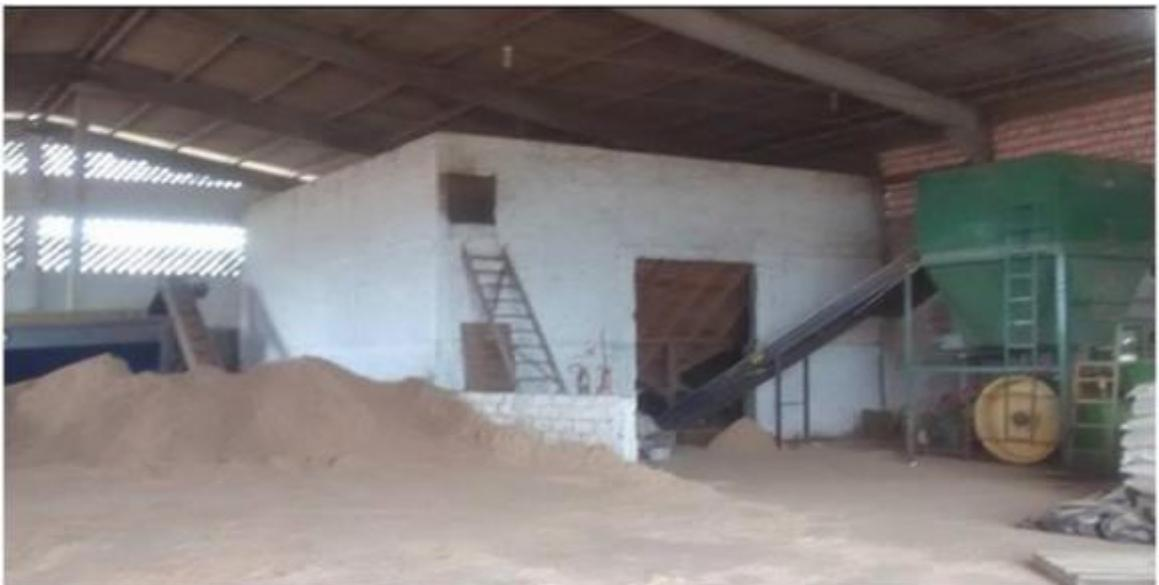
Figura 15 – Moega de armazenagem da matéria-prima seca
