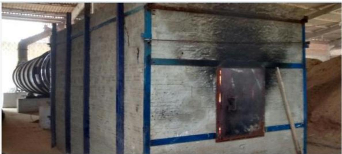
Figura 13 – Fornalha e secador da matéria-prima
