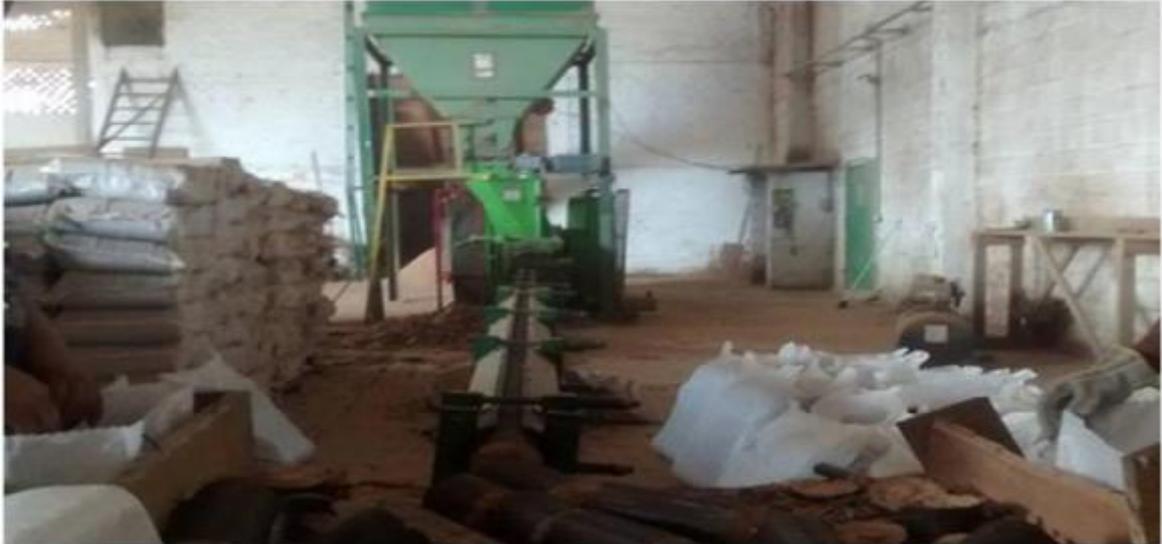
Figura 16 – Máquina briquetadeira em produção.
